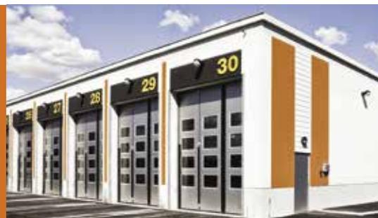
Il s'agit de portes composées de vantaux articulés l'un à l'autre, qui s'ouvrent en se repliant sur un ou sur les deux côtés de la porte, en se déplaçant le long de rails spéciaux.
