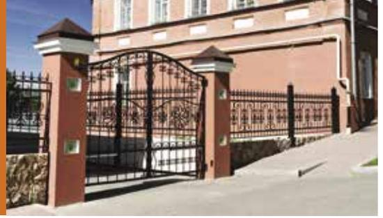
Les vantaux du portail tournent sur des axes latéraux, en s'ouvrant vers l'intérieur de la propriété. Le portail battant peut avoir un ou deux vantaux.
